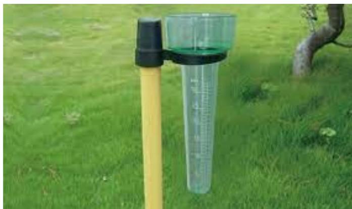
Para obtener una medida exacta, tiene importancia la calidad del instrumento que se emplea en la recolección y conservación de la precipitación hasta el momento de la medición. Hay que tratar de reducir la evaporación de la precipitación. Para ello, conviene preservar el recipiente del calor exterior. Es importante también reducir en lo posible la pérdida por el mojado de las paredes del recipiente, particularmente, cuando se trata de precipitaciones de escasa cantidad.
